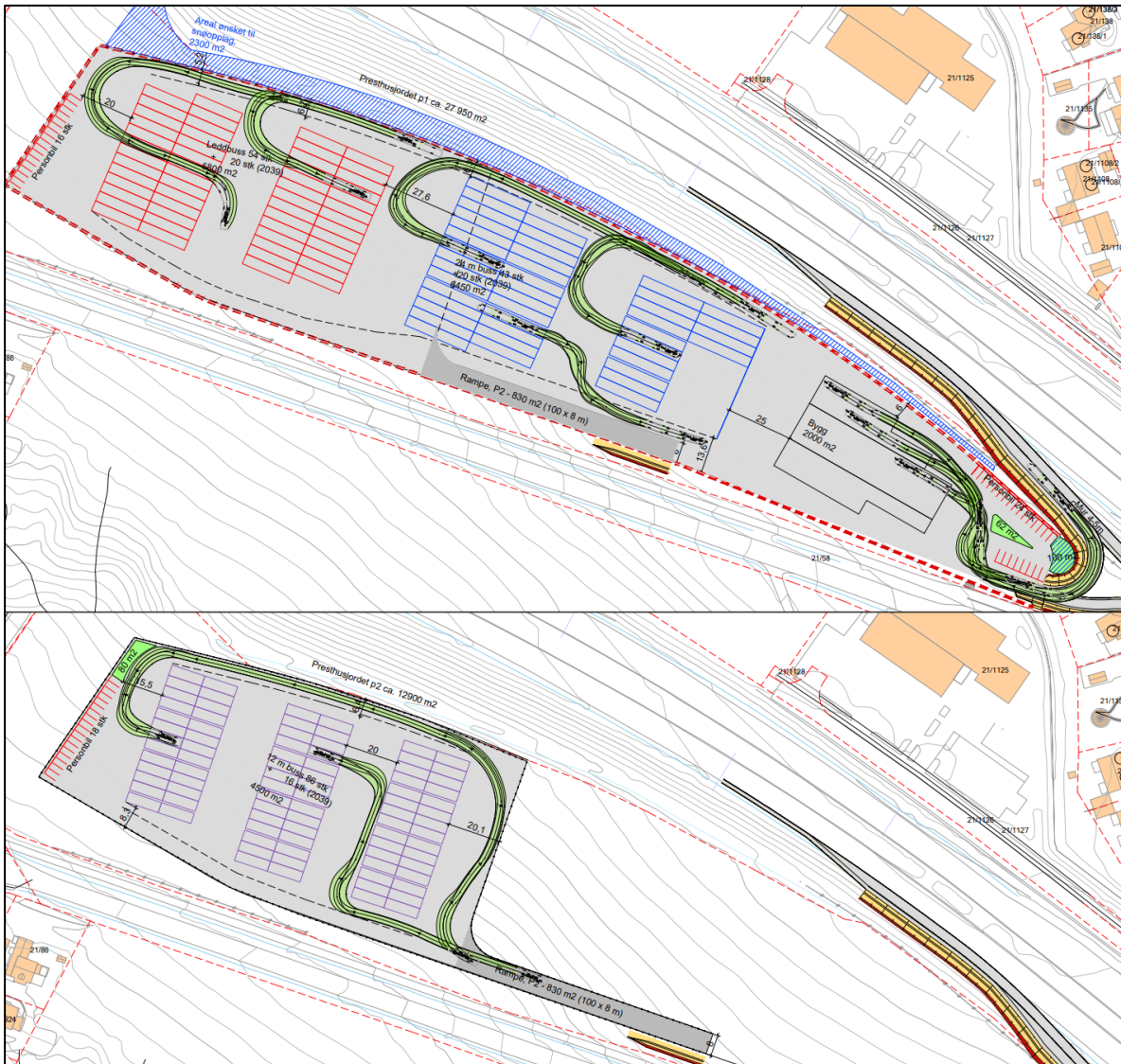
Figur 7-3: Optimalisert revidert løsning på Presthusjordet for 2029 målene. Som en forberedelse til 2039 er oppstillingsplassene lagt slik man kan øke kapasiteten ved å ta i bruk nye kolonner.
